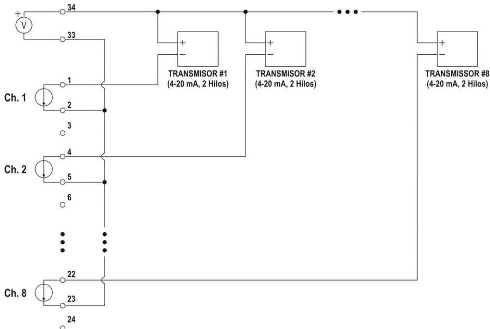
Fig. 20 – Fuente auxiliar para alimentación de transmisores 4-20 mA (2 hilos)
