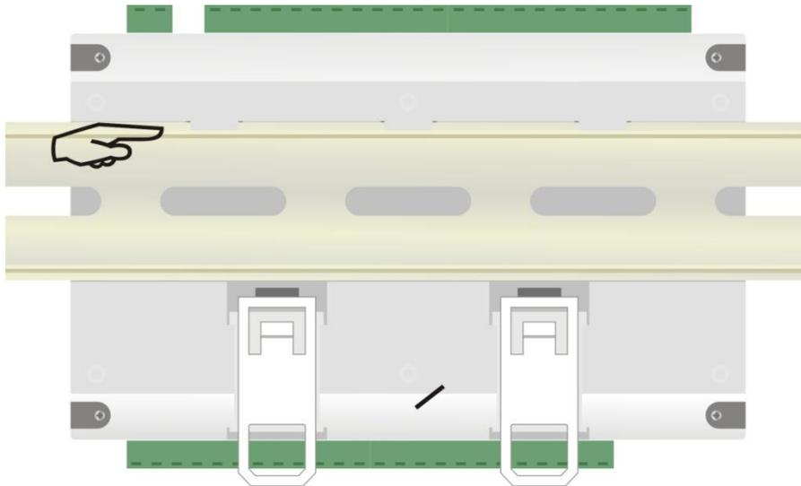
**Fig. 03** - Modo de instalación en carril DIN
