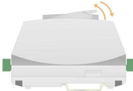
Fig. 12 – Removiendo e instalando la **IHM** en el **FieldLogger** (vista lateral)
