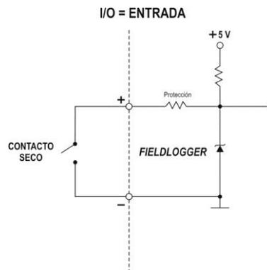
Fig. 17 - Conexión contacto seco
