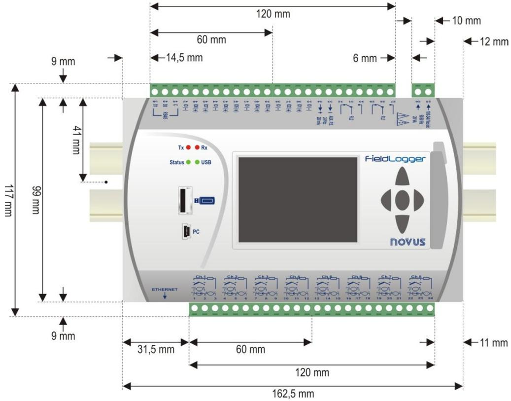
Fig. 07 – Dimensiones del *FieldLogger* con módulo IHM
