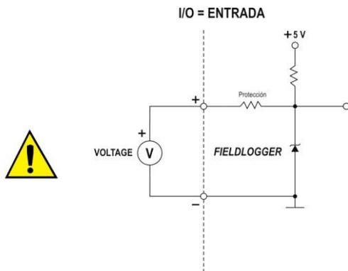
Fig. 16 - Conexión de tensión
