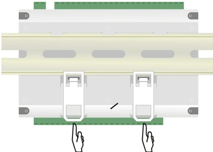
**Fig. 04** - Modo de instalación en carril DIN
