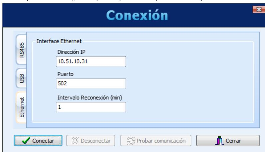
Después de efectuar la conexión aparecerá una próxima ventana con informaciones del equipo (bastante útil para asegurarse de que se está conectando el equipo correcto, especialmente cuando se colectan datos en redes Ethernet/Modbus TCP o RS485/Modbus RTU e están conectados varios equipos **FieldLogger** en la red). En esta ventana se debe elegir el local donde los registros están almacenados (flash interna o tarjeta SD).
