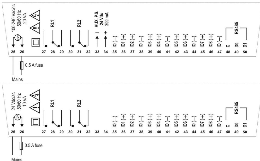
Fig. 14 – Conexiones del lado superior para la versión estándar e 24V
