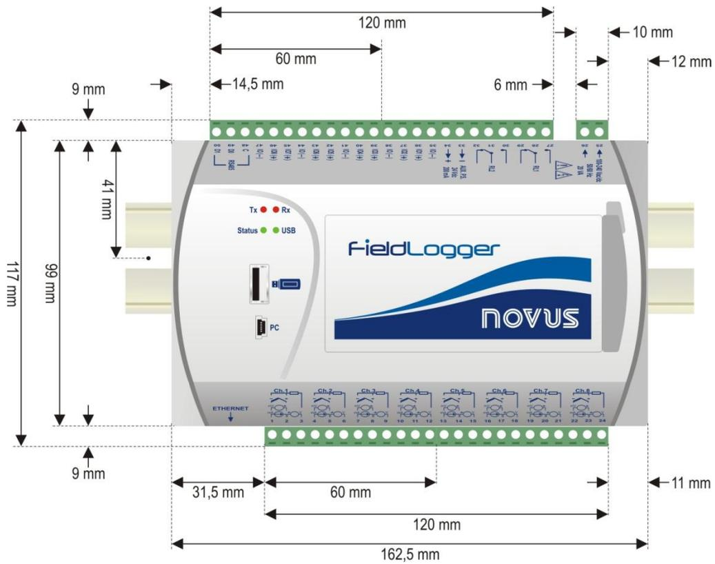
Fig. 05 – Dimensiones del *FieldLogger* sin módulo IHM
