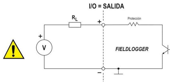
Fig. 19 - Conexión de una carga a la salida digital
