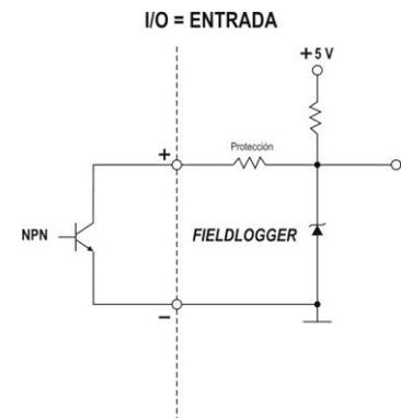
Fig. 18 - Conexión NPN
