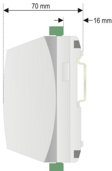
Fig. 06 – Dimensiones del lateral del *FieldLogger* sin módulo IHM
