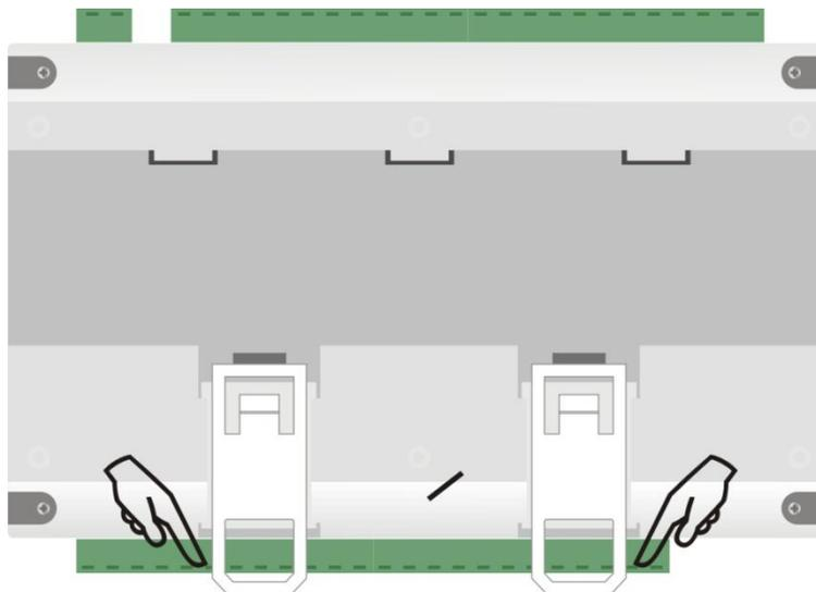
Fig. 02 – Modo de instalación en carril DIN
