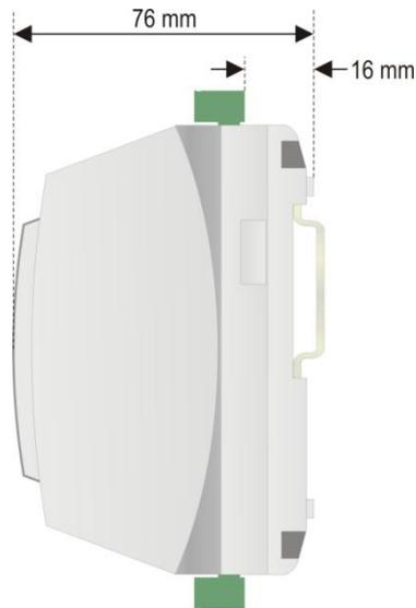
Fig. 08 – Dimensiones del lateral del *FieldLogger* con módulo IHM
