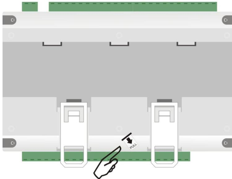
Fig. 01 – Película aisladora de la batería
