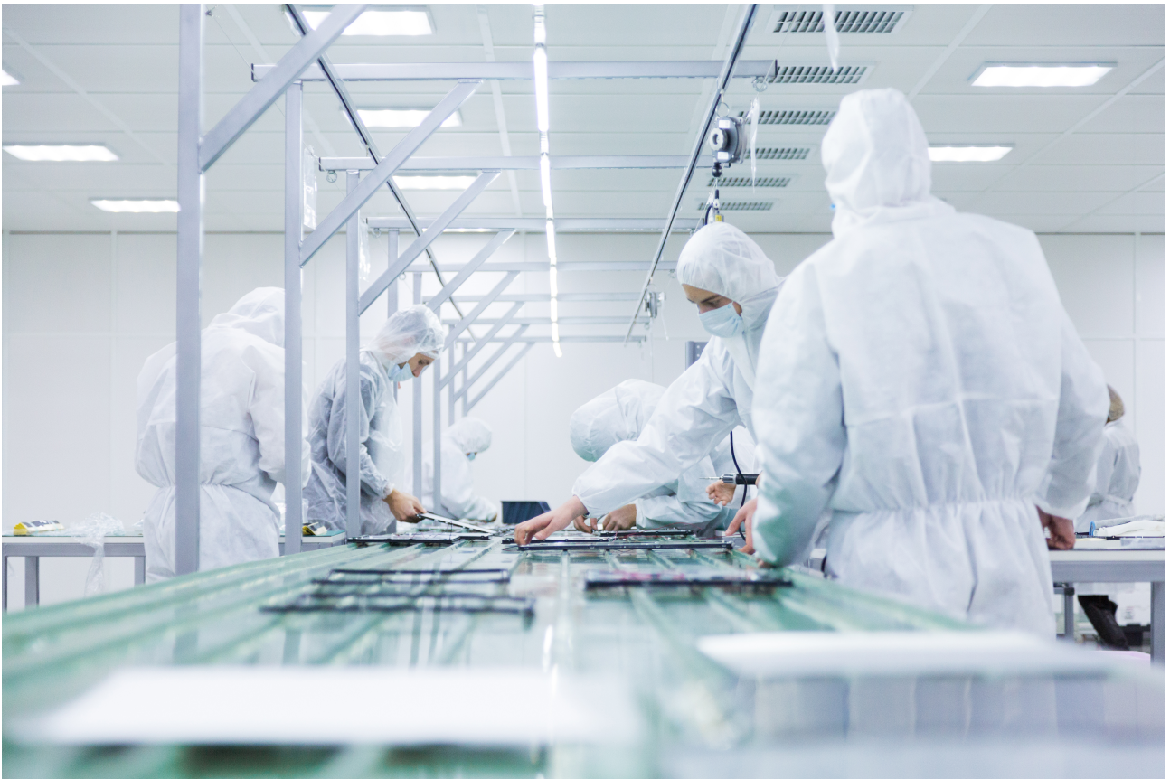
Figura 2. Operarios en sala limpia ISO 7 con sistema de control de humedad y temperatura
